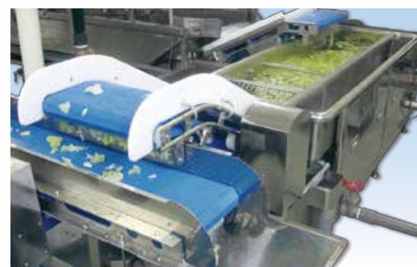
流水洗浄コンベア
